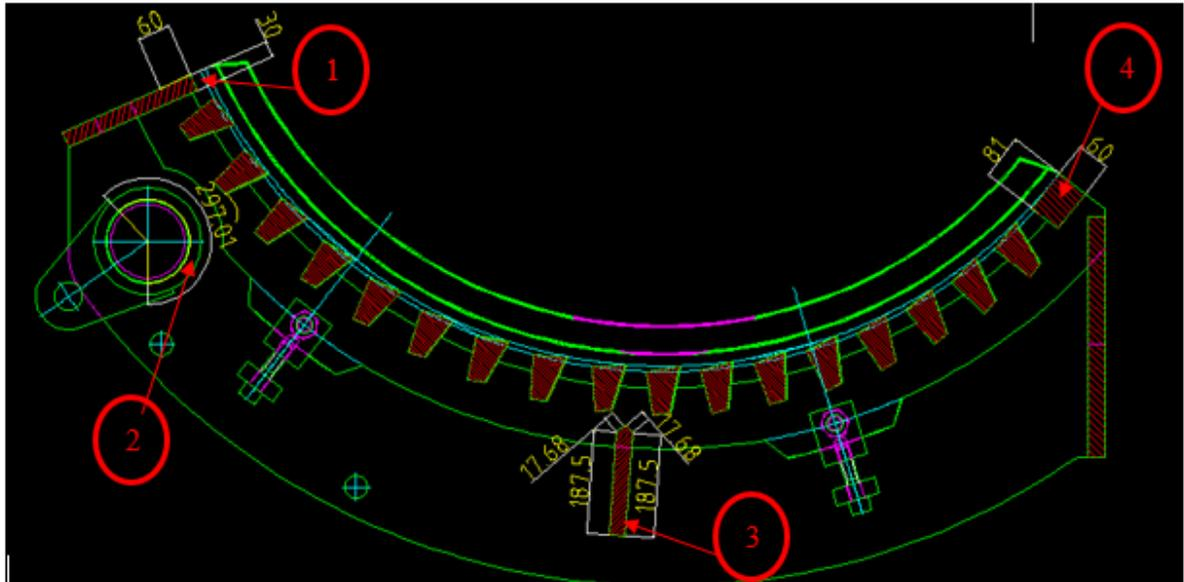
**Figura Nº 8** Posiciones a repararse en los dos canastillos
