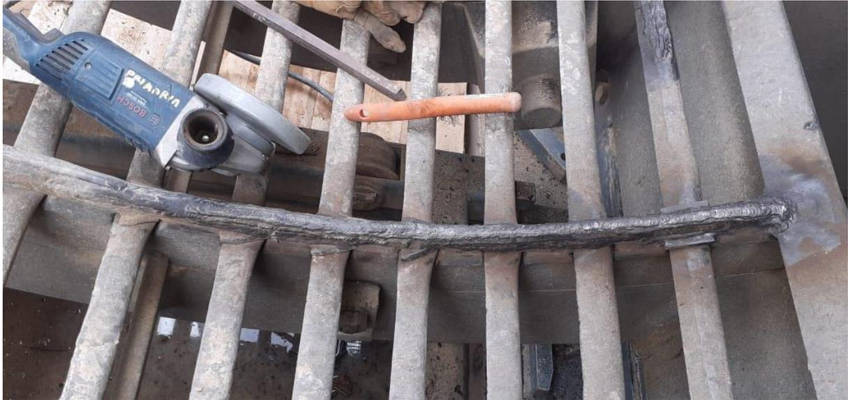
**Fotografía N°13 Relleno de con soldadura dura**
