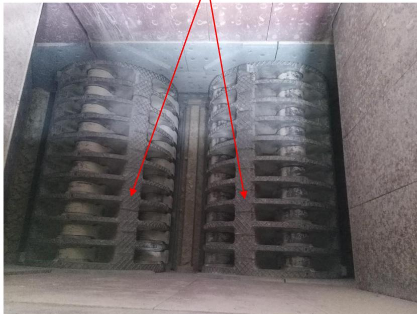
**Fotografía N°2** Discos de impacto con diferentes espesores
